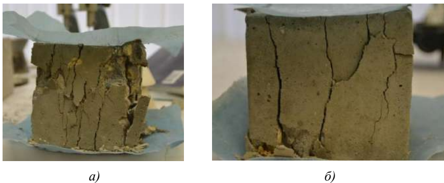
Рис. 5 Внешний вид образцов из бетона В15, испытанных со смазочным слоем с различным заполнителем: а – заполнитель щебень, б – заполнитель песок.
